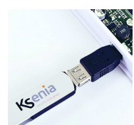
Αντάπτορας Micro-USB. Micro-A αρσενικό σε USB A θηλυκό
